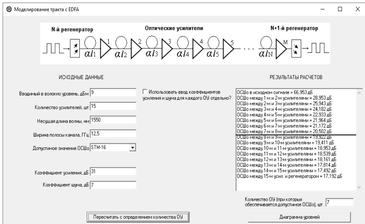
Рисунок 1 – Вікно моделювання ЛТ-1 за допомогою САПР
