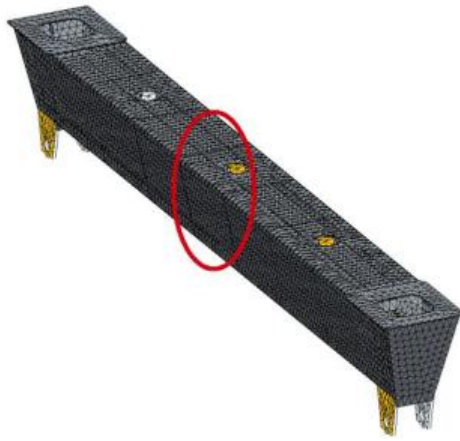
Рис. 3. Числова модель нижньої балки з пошкодженням
