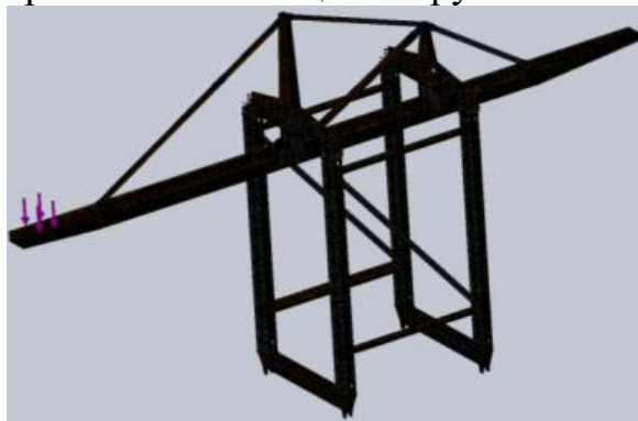
Рис. 2. Числова модель контейнерного перевантажувача
