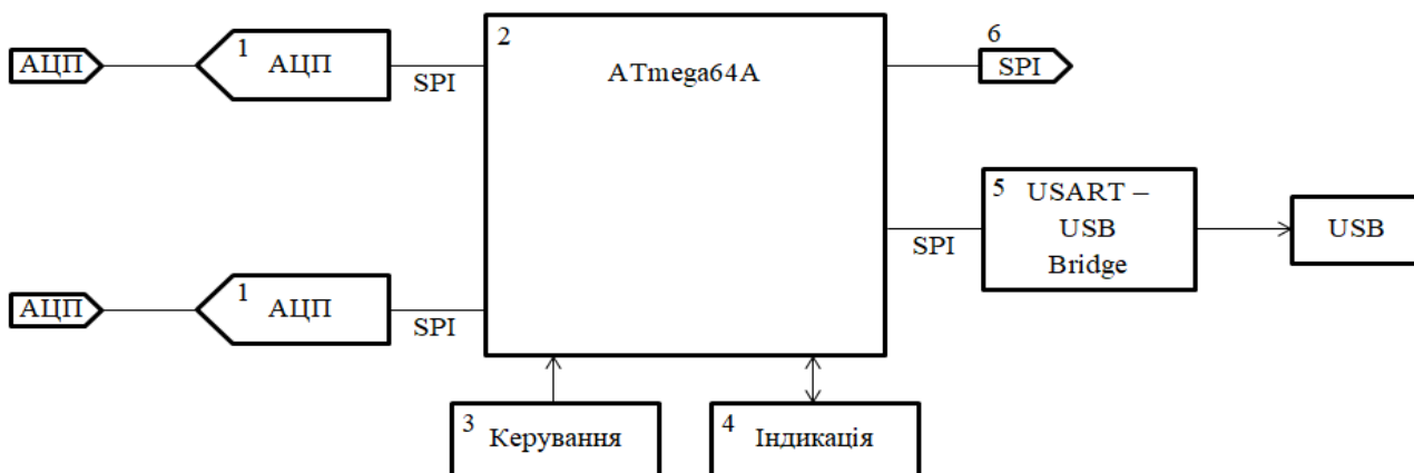
Рисунок 4 – Цифрова частина пропонованої архітектури двоканального синхронного детектора: 1 – АЦП \Sigma - \Delta ADS1292, 2 – мікроконтролер ATmega64A, 3 – блок керування (кнопки та encoder), 4 – блок індикації – LCD дисплей WH1602B, 5 – блок зв'язку з ПК – FT232, 6 – шина SPI для управління підсилювачами та АЦП.
