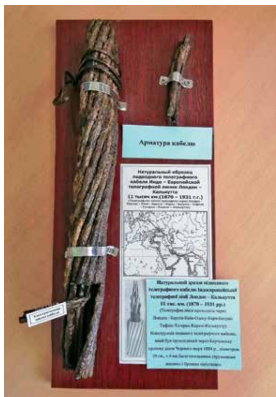
Зразок підводного кабелю Індоевропейської телеграфної лінії Лондон — Калькутта (1870–1931 рр.)
