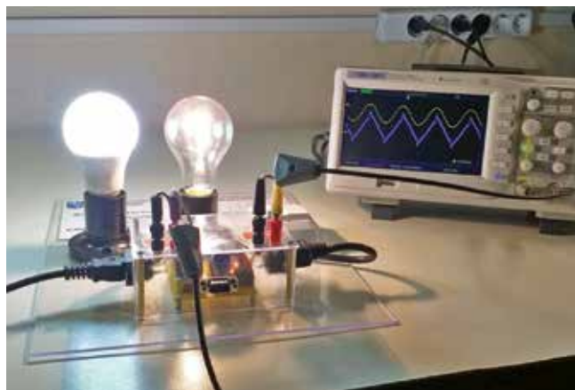
Лабораторний макет для дослідження виміральної частини лічильників електричної енергії, виготовлений студентами каф. АТП та ЕЖ (2019 р.)
