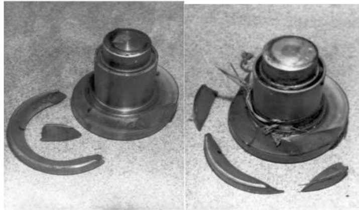
Рис. 1. Руїнування пружного елемента тензометричного датчика сили
