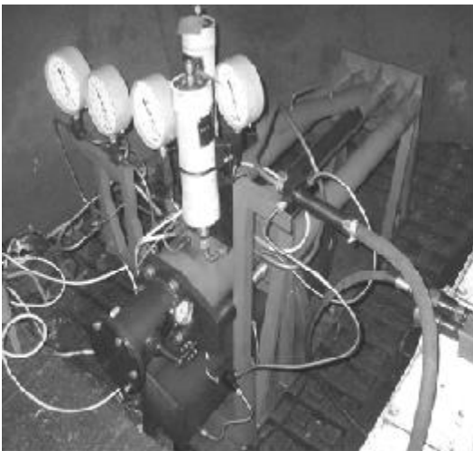
Рисунок 25 - Макет гідравлічного вібростенду
