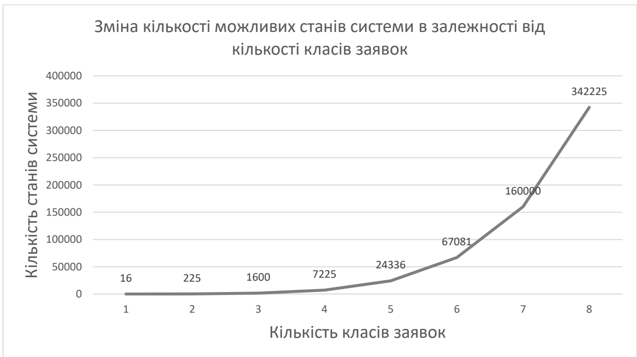
Рис. 4.2. Графік зміни кількості можливих станів системи при зміні кількості класів заявок в системі з 2 ОП та довжиною черги на обслуговування в 2 заявки
