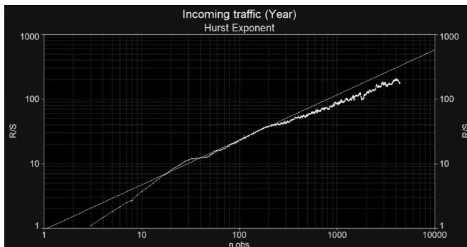
Рис. 2.11. Графічне відображення залежності \log (R/S) від \log (n) для вхідного трафіку за рік
