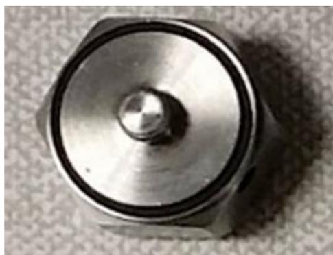
Рис.3.8. Зовнішній вигляд адаптивного механічного фільтру
