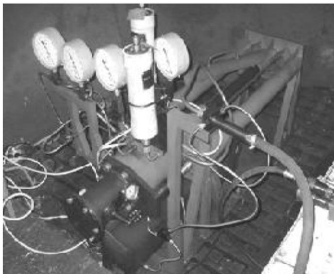
Рис.5.9. Зовнішній вид макету електрогідравлічного вібростенду
