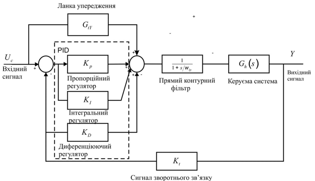
Рис.5.8. Структурна схема керування електрогідравлічним вібростендом
